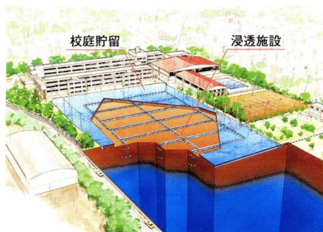
雨水貯留浸透施設
